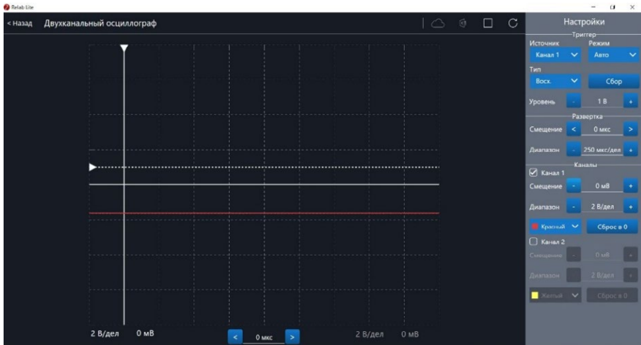
Рис. 40. Сигнал с ненулевым смещением
